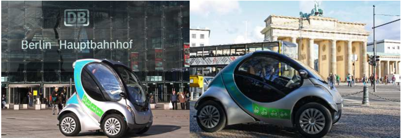
Foto links, sozusagen im Parkmodus, rechts aufgeklappt im Fahrbetrieb.
