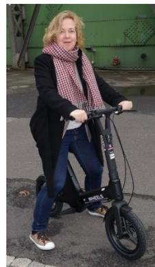
Um eine unkomplizierte Nutzung sicherzustellen, weisen die E-Bikes von WHEELS neben dem niedrigen Durchstieg ein Eigengewicht von nur 20 kg auf und sind leicht zu bedienen, da kein Pedalieren notwendig ist. Zudem sind die Fahrzeuge 30 Prozent kürzer und 50 Prozent leichter als bestehende Pedalradoptionen, was das Bedienen einfacher macht und ein höheres Sicherheitsgefühl gibt. Gefahren werden darf das Bike
